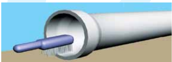
4. Tok belső felületének tisztítása
