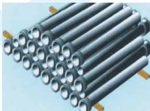
3. típus piramis elrendezés: tok és csővég egymás felett
