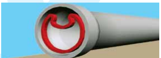
5. Gumi tömítés behelyezése a tokba
